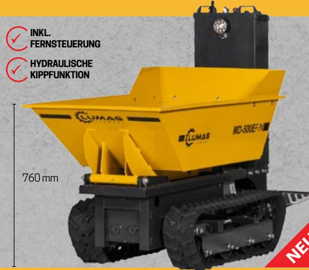
Motorleistung 1.500 W (2x 750 W), Nennspannung 48 V
