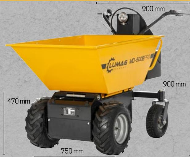
Motorleistung 750 W, Nennspannung 48 V
