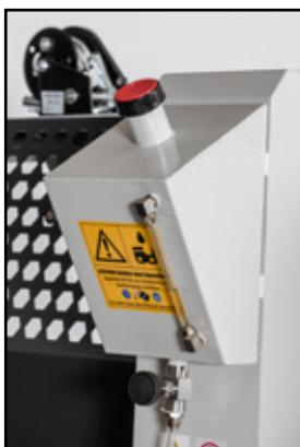
(q) Schmiersystem Tank mit Dosierventil
