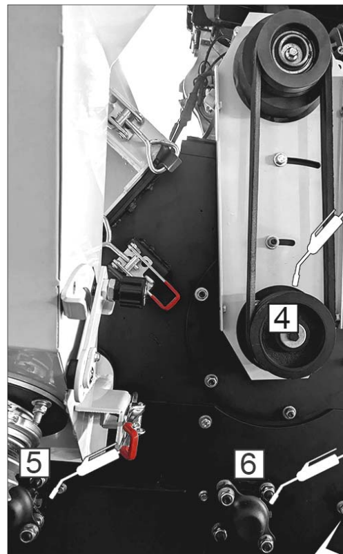
Schmierstellen Trommelhackwerk und Gebläserad
