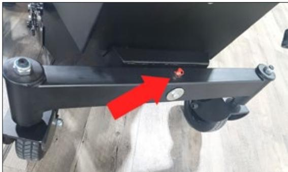
*Den Drehpunkt der Pendelachse alle 80 Betriebsstunden nachschmieren.*
